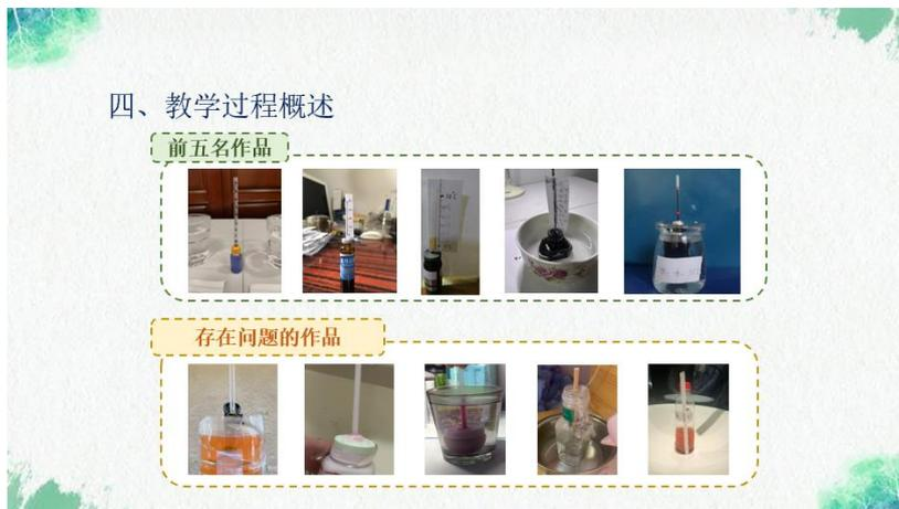
问题 1：简易温度计放入热水中后，液面上升不明显，是由于在温度变化相同的情况下，吸管较粗，水的高度变化较小。
