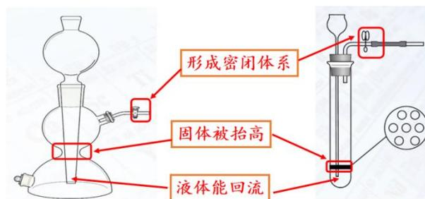
【引导】这一套固液不加热装置是否也可以改成简易启普发生器？
