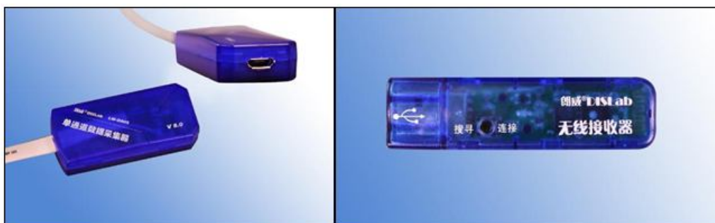
图 9 单通道有线采集器（左）、单通道无线采集器（右）
