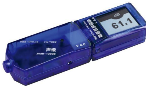
图 11 声级传感器与传感器数据显示模块连接
