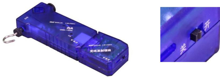
图10 传感器与无线发射模块
