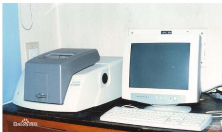
红外光谱仪是利用物质对不同波长的红外辐射的吸收特性，进行分子结构和化学组成分析的仪器。
