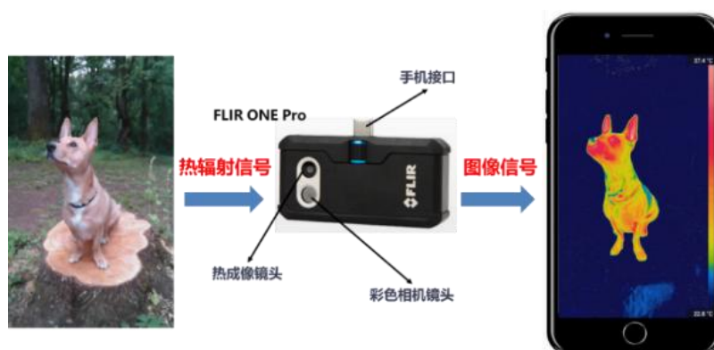
图 1 热成像仪工作原理示意图
